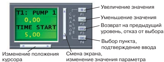
Рис. 3. Работа с кнопками управления логического модуля
