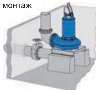
Вертикальный сухой монтаж
